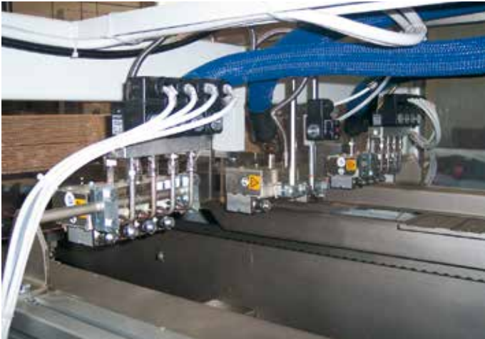
Additional glue gun for short side doubling Pistola aggiuntiva per raddoppio testate Zusätzliche Pistole für verdoppelte Kopfseiten Pistola adicional para pared doble de las partes superiores
