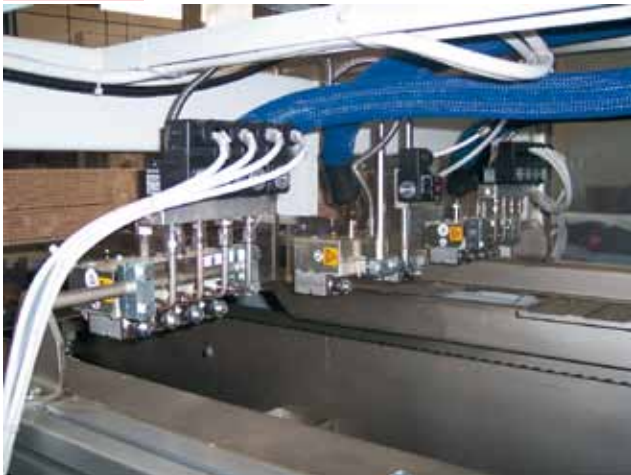
Additional glue gun for short side doubling Pistola aggiuntiva per raddoppio testate Zusätzliche Pistole für verdoppelte Kopfseiten Pistola adicional para pared doble de las partes superiores
