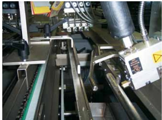
Glue can be applied lengthwise or sidewise, additional glue guns for lengthwise glue application Possibilità di applicare la colla longitudinalmente o trasversalmente, pistole colla aggiuntive per colla longitudinale Leimauftragen in Längs- und Querrichtung möglich, zusätzliche Pistole zum Leimauftragen in Längsrichtung Posibilidad de aplicar la cola longitudinalmente o transversalmente, pistolas de cola adicionales para cola longitudinal
