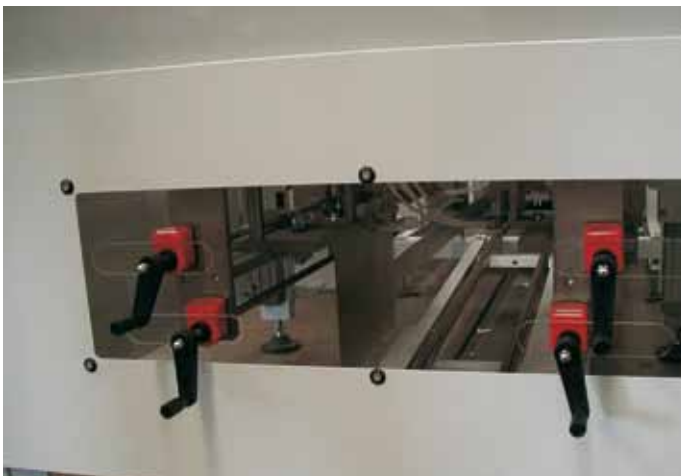
Central adjustment units for quick format changeover Regolazioni centralizzate per cambio formato rapido Zentralisierte Einstellungen für schnellen Formatwechsel Regulaciones centralizadas para cambio rápido de formato
